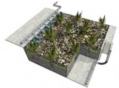
Vista general de un Humedal de flujo horizontal
