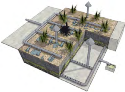
Vista general de un Humedal de flujo vertical
